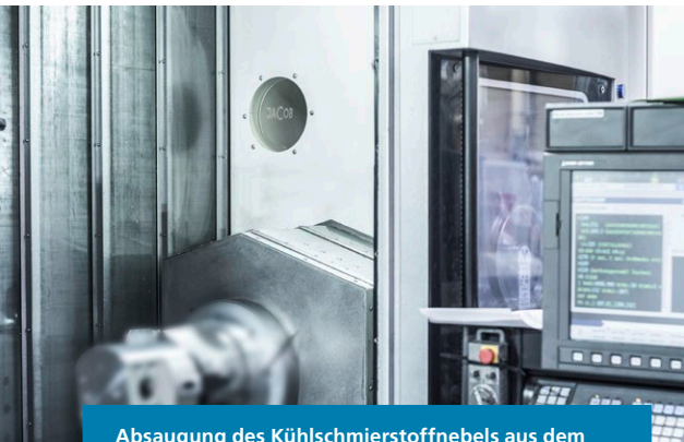
Absaugung des Kühlschmierstoffnebels aus dem Bearbeitungsraum
