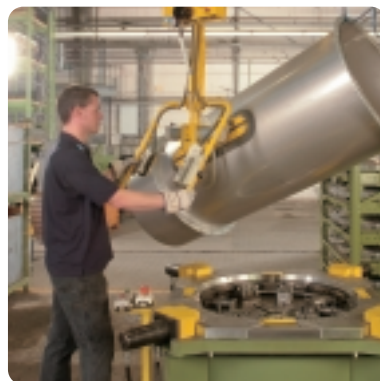
Stark in Serie: Qualitätsbördeln der XL-Rohre bis DN 800 mm.
