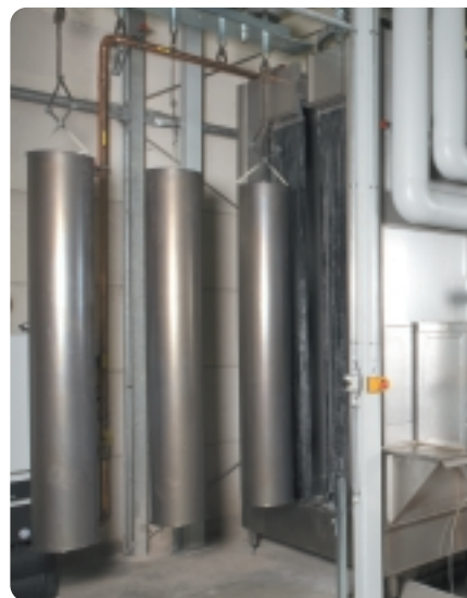
Qualitätskontrolle – Hochwertig pulver- beschichtete Rohre verlassen die Aufsprühkabine.
